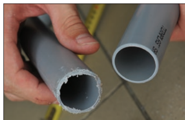
Рез ножовкой (слева) по сравнению с P-TEC 3240 (справа).
