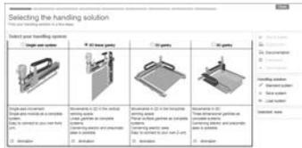
Проектирование и конструирование сложных систем перемещения, например, для применения «pick & place», как правило, требует много времени. При помощи инновационного инструмента Handling Guide Online (HGO) вы можете создать систему по индивидуальным расчетам, произведя всего несколько шагов. Предельно просто, основываясь на своих прикладных данных, таких как масса нагрузки, путь перемещения и время цикла.
