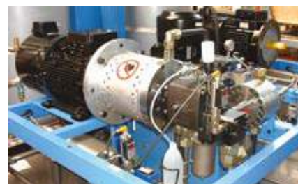
Не требующая обслуживания герметизация дозирочных насосов литьевых машин высокого давления для полиолов и изоцианатов.
