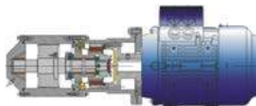
MINEX®-S для герметизации гомогенизаторов тяжёлых нефтепродуктов для морского применения
