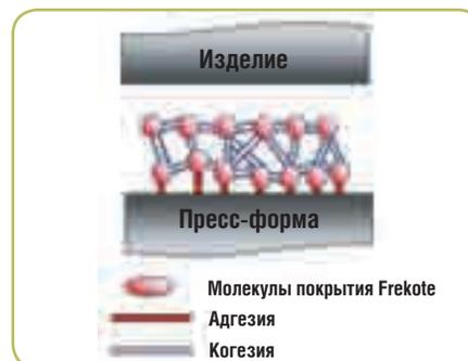
Полупостоянные покрытия создают на поверхностях пресс-форм плёнки с малой поверхностной энергией.
