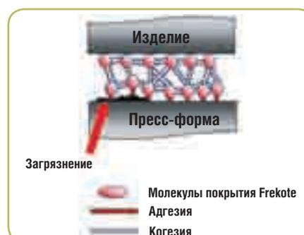
Загрязнение может ослабить адгезию покрытия Frekote® к поверхности пресс-формы.
