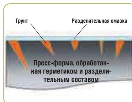
Герметики заполняют поры поверхности и делают её идеально гладкой
