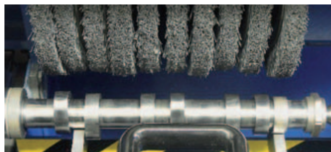
Стр.59 в самом низу справа Снятие заусенцев на краях среза
