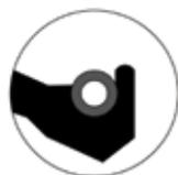
Традиционная (открытая) конструкция канавки пружинного кольца
